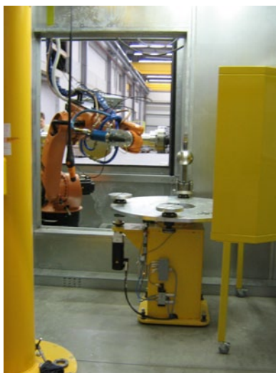
HVOF K2 Turn-Key Center: Beschichtung von Ventilkugeln Coating of ball valves
